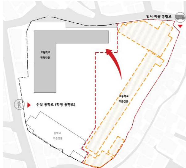
2 고등학교 학생 개축 건물로 이동 기존 고등학교 및 생활관, 창고 철거
