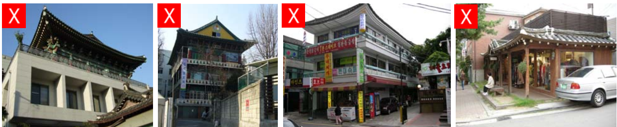
비한옥상부에 한옥을 얹음 콘크리트로 한옥 모사함 콘크리트로 한옥 모사함 외관에 한옥형태를 모사한 구조물 부착
