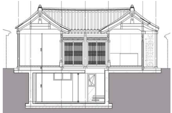
기단부 아래의 지하부분이 콘크리트구조로 되어 있는 한옥
