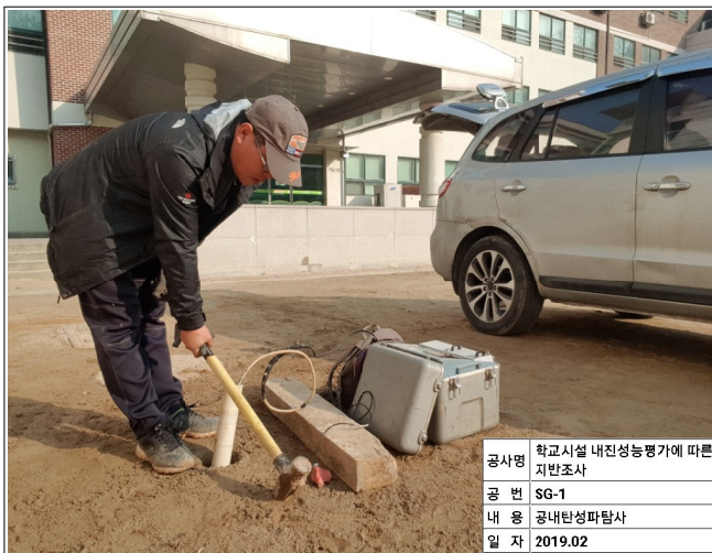
사진내용 Hammer 타격 및 기록(P파 측정)
