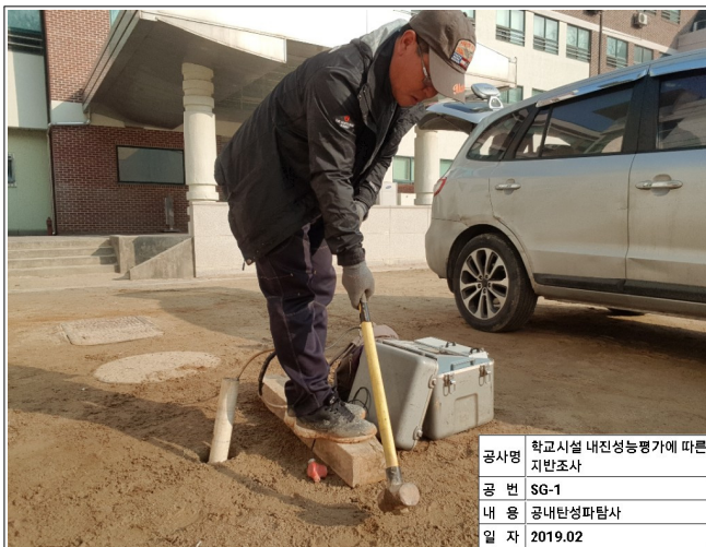
사진내용 Hammer 타격 및 기록(S파 측정)
